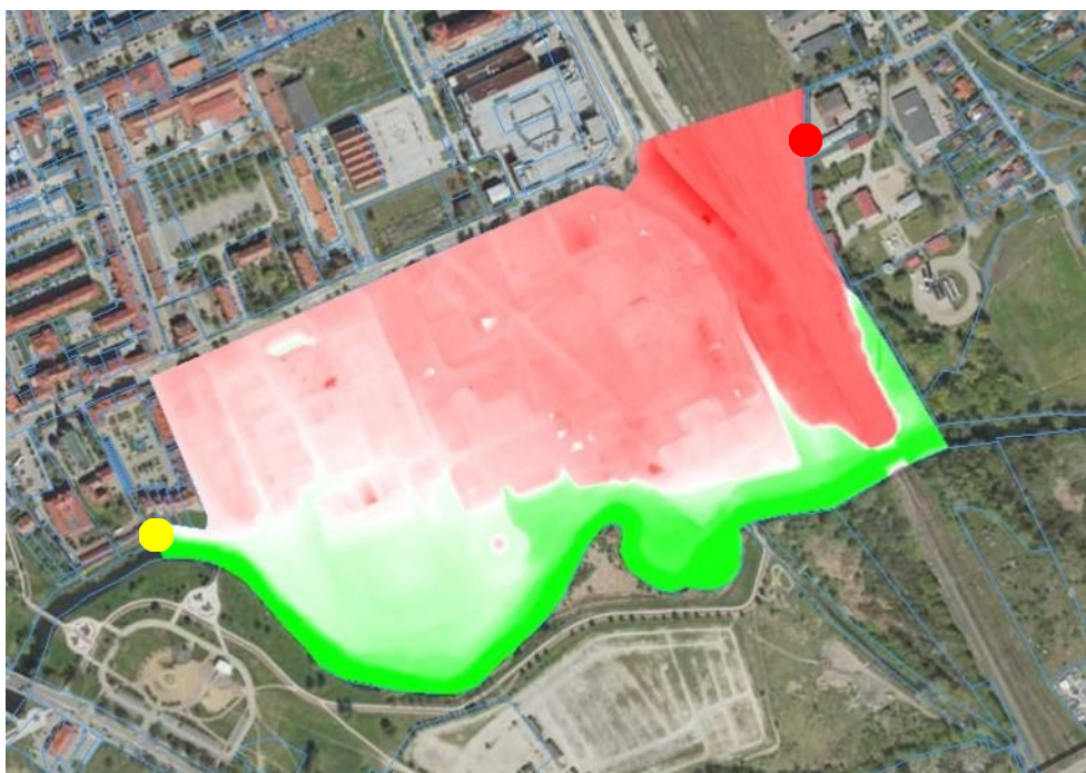
Ryc. 4. Różnice wzniesień w granicach opracowania ● 122,18 mnpm ● 127,73 mnpm
