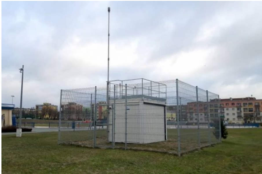
Ryc. 39. Automatyczna stacja pomiarowa jakości powietrza w Elku
