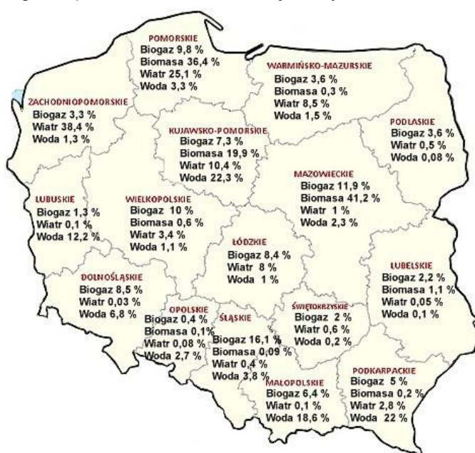
Rys. 13-1. Oszacowanie teoretycznego potencjału odnawialnych źródeł energii na terenie Polski obrazujące różnice jakie występują w posiadanych zasobach pomiędzy poszczególnymi regionami. (Źródło: ARE 2010)
