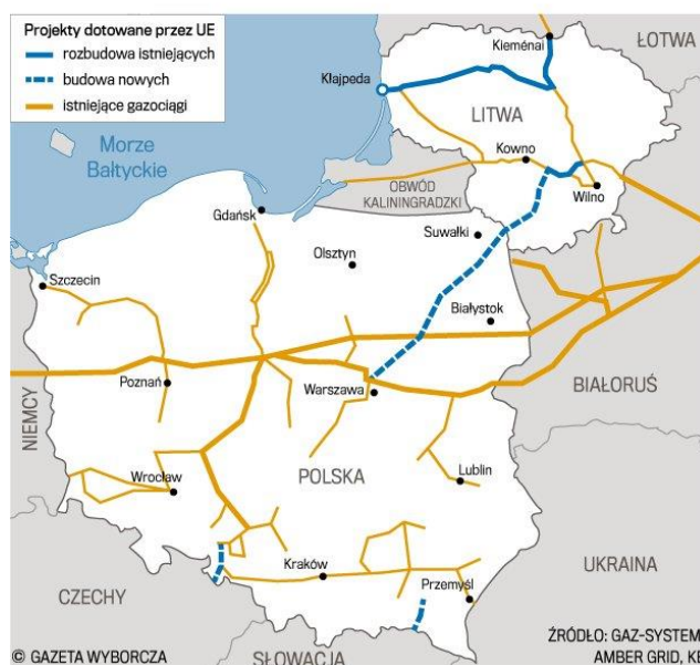
Rys. 3. Przebieg gazociągu transgranicznego przez teren Polski.
